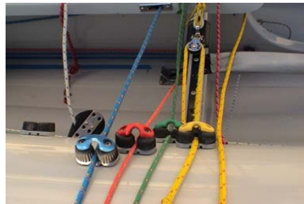
Figura 21 –trapa, cunningham de la mayor, carro del foque y carro de la mayor, colocados delante del caña
